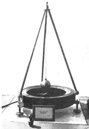
Figura 1: Fotografia del pèndol simple horitzontal construït a París al voltant de 1880. Una punta de vidre a l'extrem inferior del pèndol dibuixava una gràfica sobre un casquet esfèric de vidre prèviament fumat (de Macelwane, 1947).
